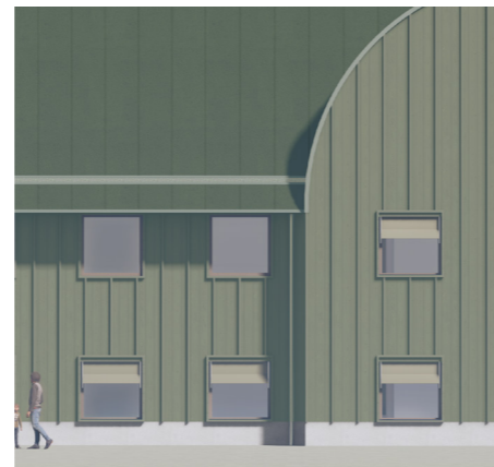
Grönt grundval Träpanel och takpapp med plåtdetaljer, solavskärmning på fönster i solutsatta lägen.
